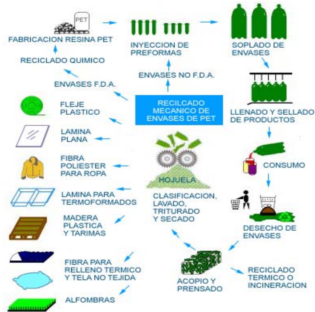
Diagrama 1. Ciclo productivo y de vida del Polietilen Tereftalato
