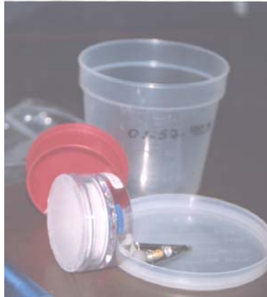
Figura 1. Monitor de difusión pasiva para detección de nicotina en aire
